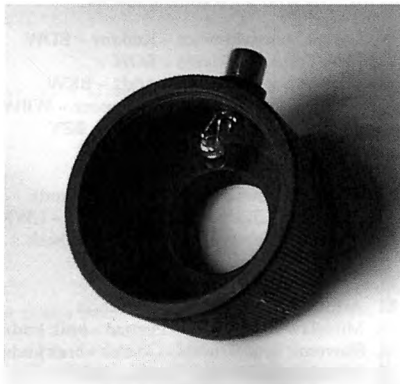
Zdjęcie przedstawia pierścień redukcyjny kamery CCD z wmontowaną diodą z gniazdem.
