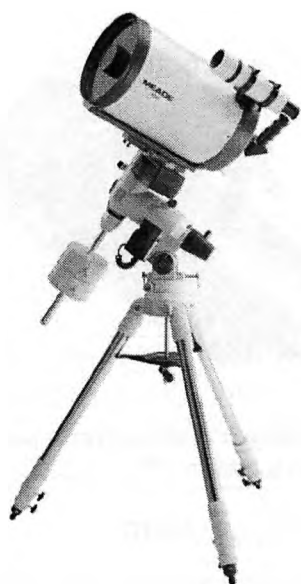
Meade LDX 75 8SC i Celestron Advanced C8NGT — połączenie klasycznych montażu niemieckich z funkcją GOTO (źródło dla lewego obrazka — www.meade.com , dla prawego obrazka — www.celestron.com ).
